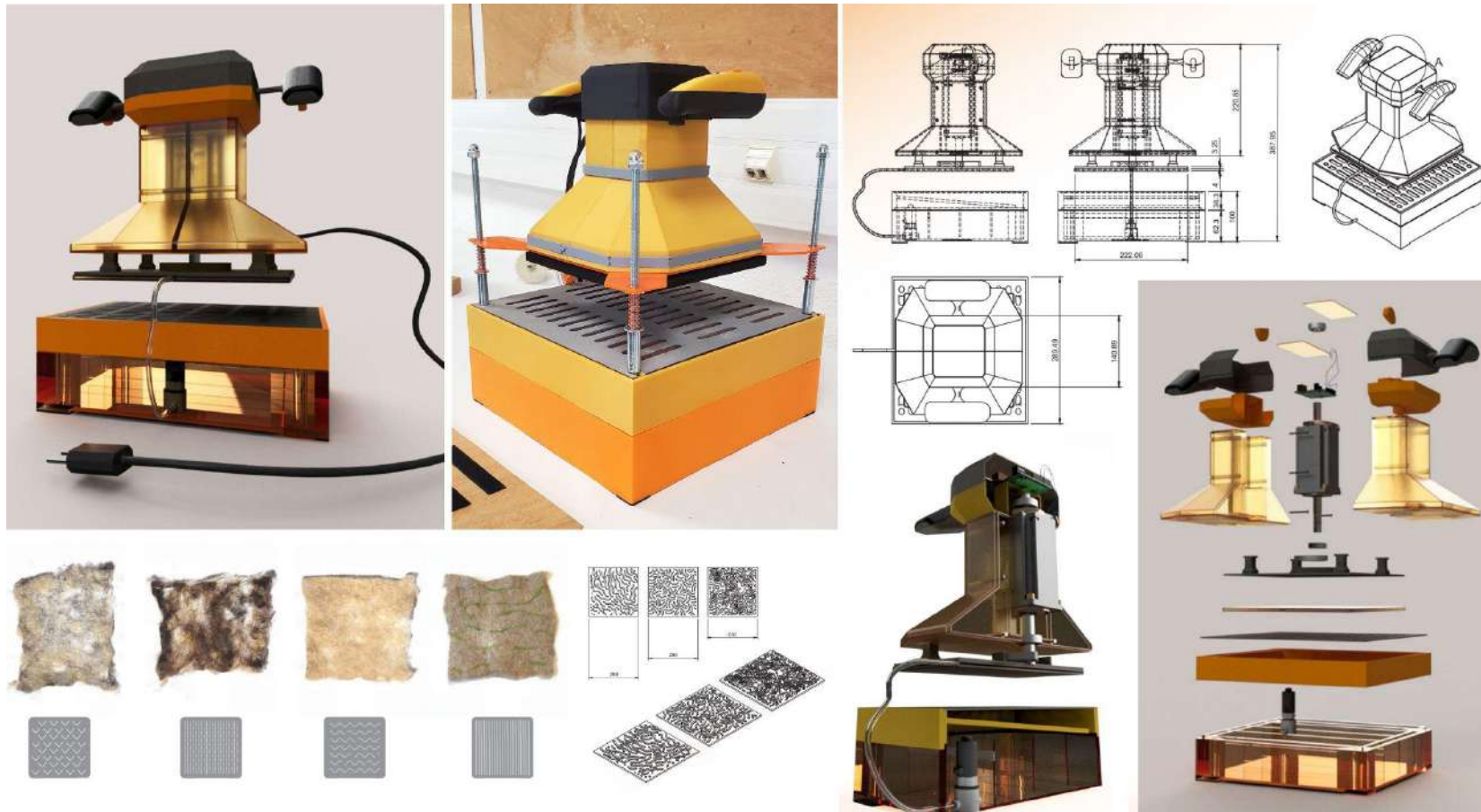
Machine pour feutrer la laine de façon semi-automatique en permettant une expérimentation autour de la matière
